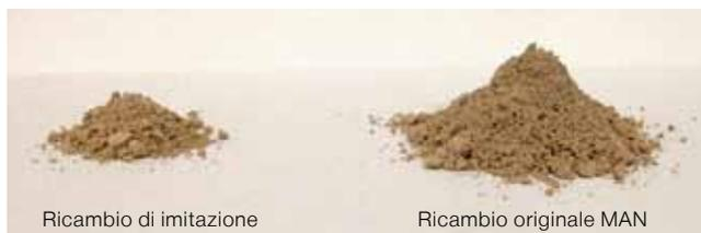
Differenti capacità di assorbimento delle impurità per gli elementi filtranti originali MAN e per i pezzi di imitazione.
